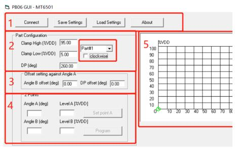
图 5.7.2 单点加斜率简化界面
