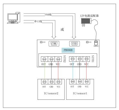
图 3.1 PB006B 编程器与2 颗 MT6501CT 的接线图
