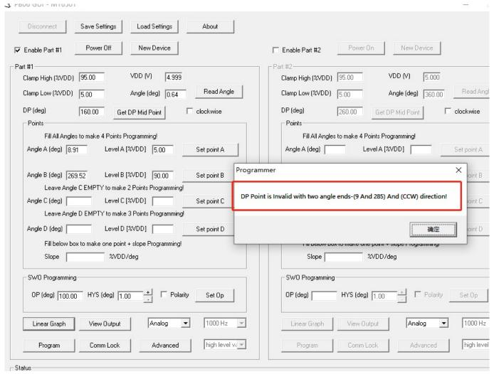
图7.4.1 芯片(磁铁)转动方向设置异常
