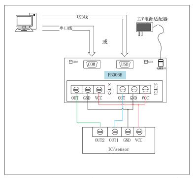
图 3.2 PB006B 编程器与1 颗单电源供电的MT6501GT 芯片接线图
